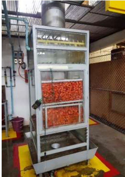
Figura 2. Torre de enfriamiento del Laboratorio de Ingeniería Química.
